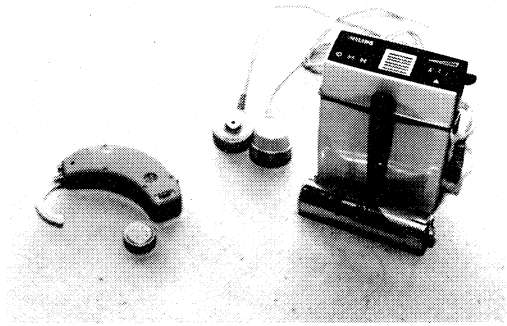
Foto 13-1: Het kastoortoestel (rechts) en de oorhanger (links): niet altijd gelijkwaardig.
