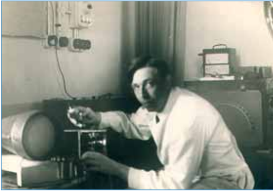
Figuur 6. Het 'Acustisch Laboratorium' begin 1930 met de in 1929 aangetrokken fysicus Henk C. Huizing. Let op de apparatuur uit die tijd, met van links naar rechts een kathodestraal-oscillograaf, een toongenerator met daarop een voltmeter.
