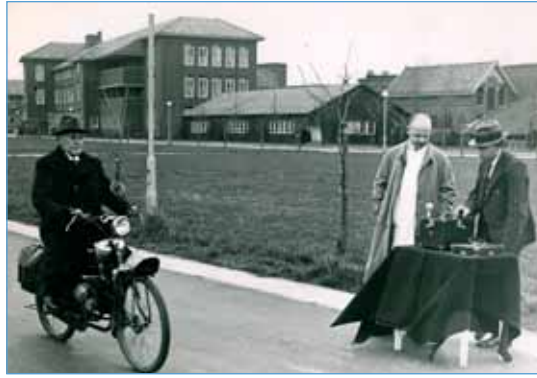
Figuur 7. Lawaaimetingen in 1937. Meting van lawaai van de ploffiets van Benjamins door de fysicus Huizing, de assistent Weersma en de amanuensis Volckman.
